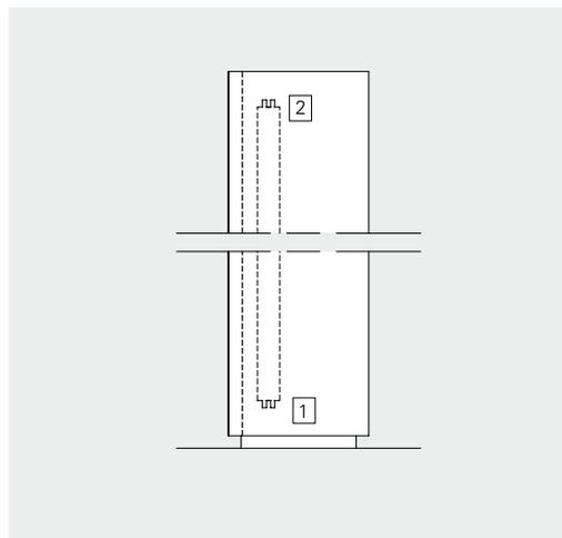
Рис. 1 Снизу (1) или сверху (2), внутренняя разводка.
